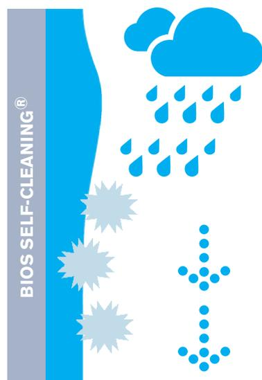
L'acqua piovana si espande sulla superficie di **Bios Self-Cleaning®** generando un sottilissimo strato che deterge ed elimina lo sporco precedentemente decomposto dall'ossigeno attivo. Rainwater spreads onto the **Bios Self-Cleaning®** surface, forming an extremely thin layer that cleanses and removes the dirt that has been decomposed by the active oxygen.
